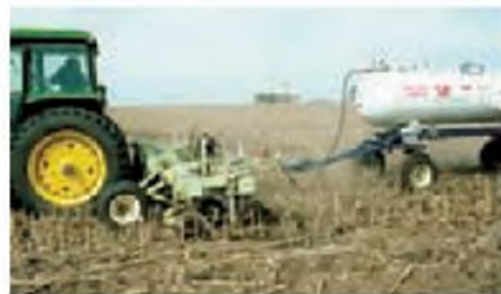
▲ Figura 15.5 Amoníaco líquido utilizado como fertilizante. El amoníaco, producido mediante el proceso Haber, puede adicionarse directamente al suelo como un fertilizante. El uso agrícola es la aplicación individual más grande del NH_3 que se produce industrialmente.
